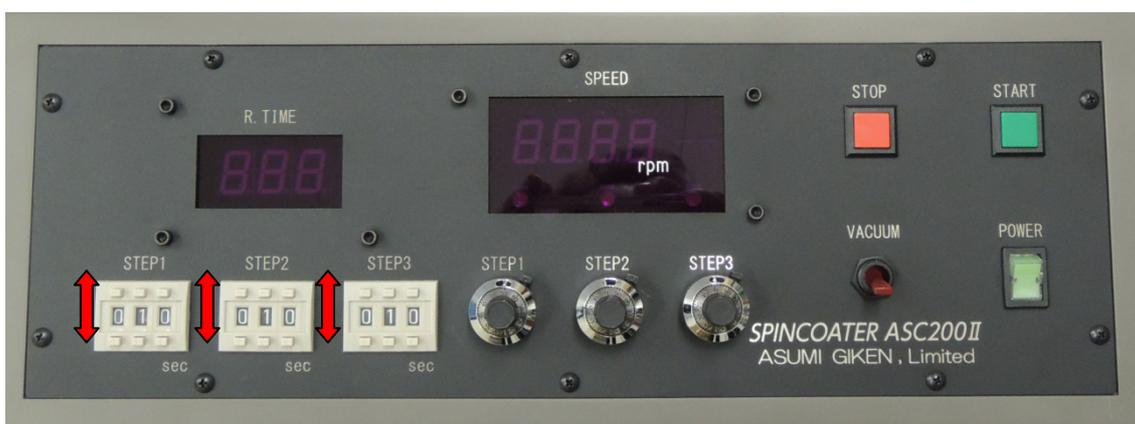
ここで設定した回転時間は、回転開始からカウントが始まり、設定された時間が経過した後に次のステップに移行し、次のタイマーのカウントが始まります。
